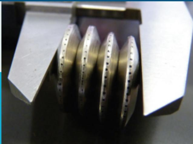
Composto de alta concentração de CBN (90%), indicado para usinar componentes temperados na amplitude de 45 a 70 HRc.
