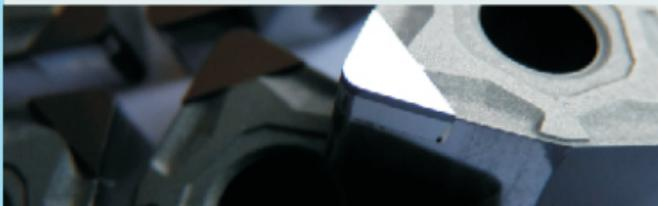
O nitreto cúbico de boro policristalino (CBN) pode ser aplicado em insertos, hastes ou sob desenho: a ferramenta certa para desbaste e acabamento em materiais ferrosos com a máxima durabilidade e precisão.
